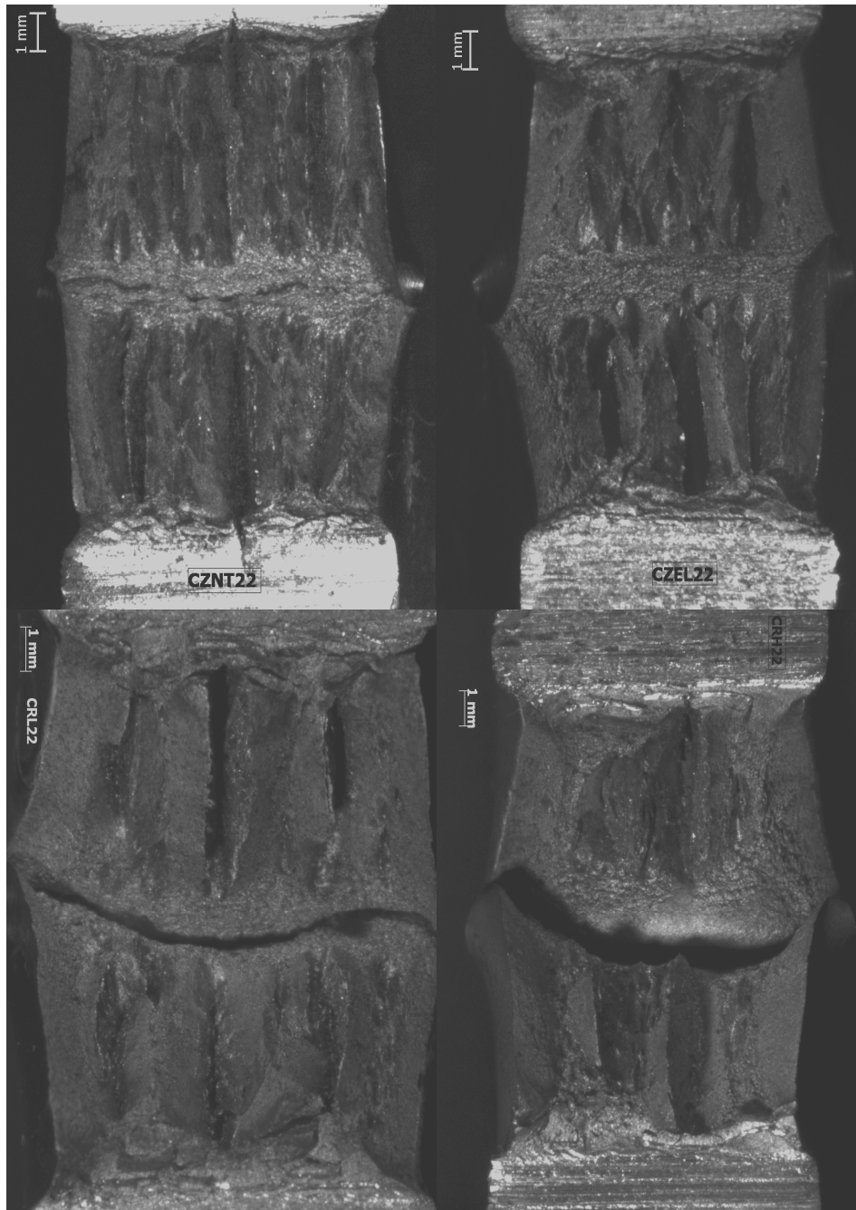
Figura 4 – Diferentes tipos de delaminação para a temperatura de -20°C
